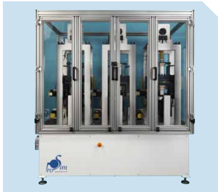
Üç istasyonlu, bağımsız olarak kontrol edilebilen, yükte bekletme istasyonu olan diz aşınma simülatörü
